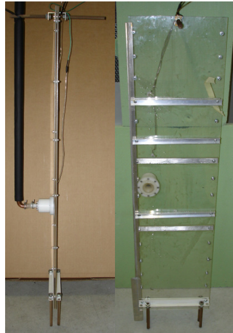
Abb. 1: Am SPF entwickelte Schichtladeeinrichtung aus zwei parallelen Platten.
