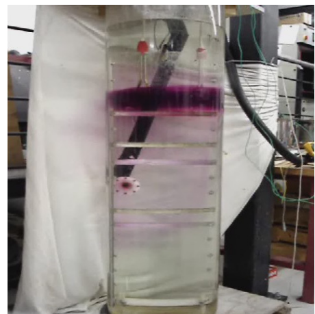
Abb. 4: Resultierende Einschichtung des einströmenden Wassers mit etwa 40 °C.
